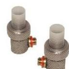
**Zpožďovací tělíska** – malá součástka, která se používá společně s jednoměničovou sondou pro zpomalení impulsu při měření tenkých materiálů
