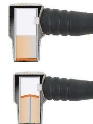
**Dvouměničová** – skládá se ze dvou krystalů umístěných v jednom pouzdře a oddělených akustickým těsněním
